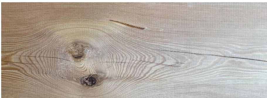
Рис.1. Образец детали из древесины со смоляным кармашком, выпадающим сучком и механическим повреждением
